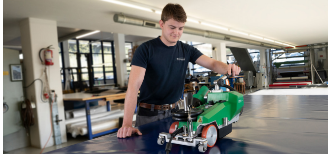
UNIPLAN 300/UNIPLAN 500: ideaal voor overlap-, zoom- en kederlassen. Hetzij op de tafel of op de vloer.
